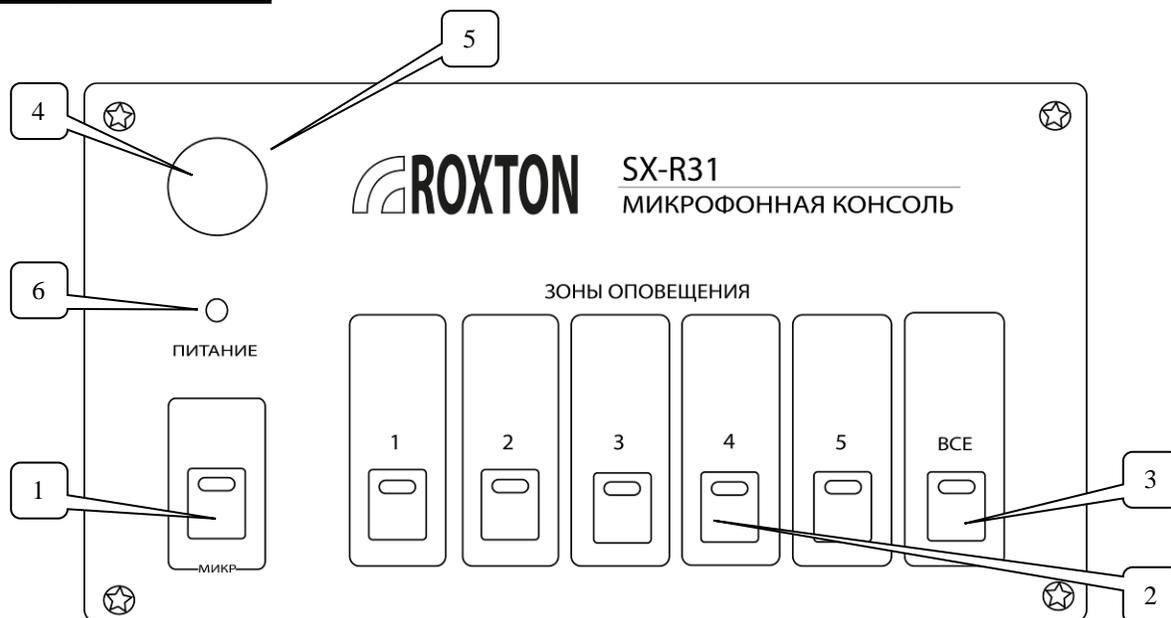
**1. Кнопка (МИКР):** Кнопка МИКР предназначена для подключения звукового тракта микрофона к моноблоку. При нажатии данной кнопки происходит включение микрофона, которое визуально отображается включением светодиодного кольца на гусе микрофона (ПОЗ 5).
