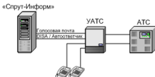
Рис.77. Использование комплекса «Спрут-Информ» на внутренних абонентских линиях УАТС
