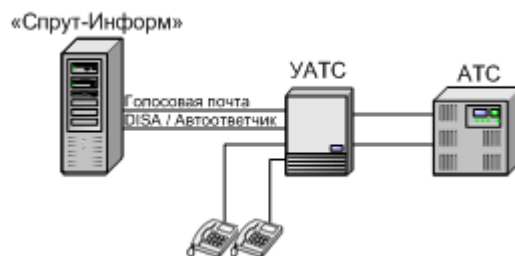
Рис.3. Использование комплекса «Спрут-Информ» на внутренних абонентских линиях UATC
