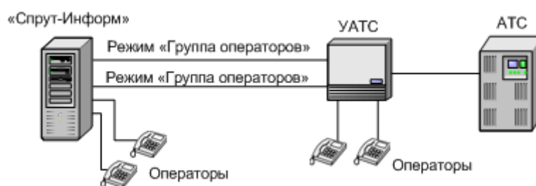
Рис.4. Использование комплекса «Спрут-Информ» в режиме «Группа операторов» для абонентов UATC и операторов, подключенных к комплексу через FXS-порт
