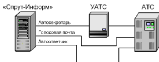
Рис.81. Использование комплекса «Спрут-Информ» на абонентских линиях АТС
