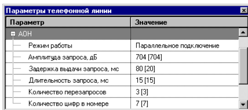
Рис.58. Настройка параметров работы АОН
