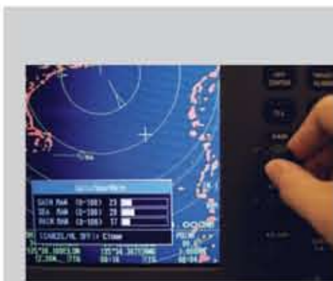
Специальные поворотные переключатели, регулирующие функции GAIN/STC/FTC для эффективной работы.
