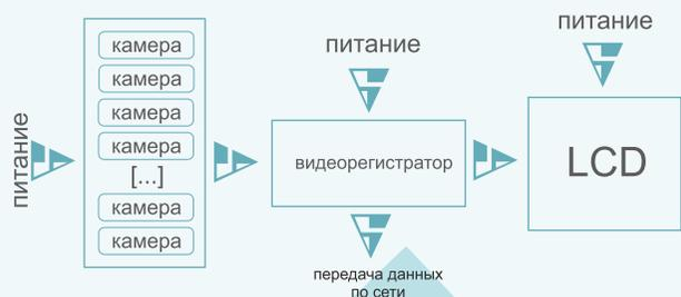
Аналоговая система Миран™- это первая система охранного наблюдения, одобренная PPP и PMPC, которая использует технологию AHD(Analog High Definition). Эта технология позволяет передавать видеоизображение высокого качества(720P) по коаксиальному кабелю на расстояние до 500м. Что несравнимо выше, чем в классических аналоговых системах.
