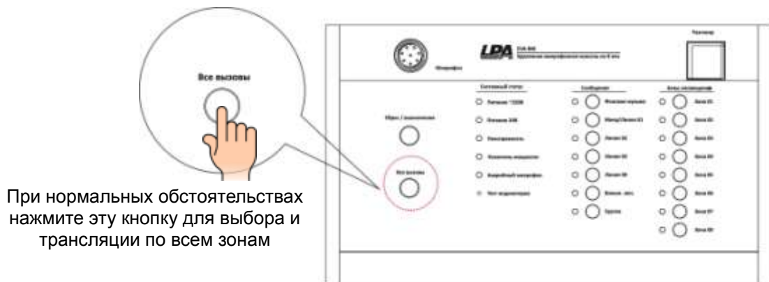
Рис. 4.4. Выбор всех зон оповещения на микрофонной консоли LPA-EVA-RM
