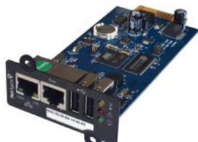
Карта SNMP с подключением датчика окружающей среды
