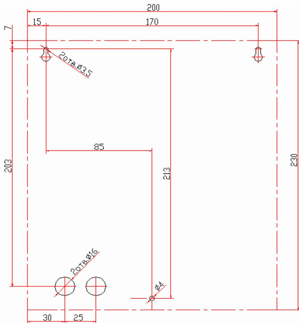
**Рисунок 2 – Разметка отверстий для установки контроллера PERCo-CT/L04
