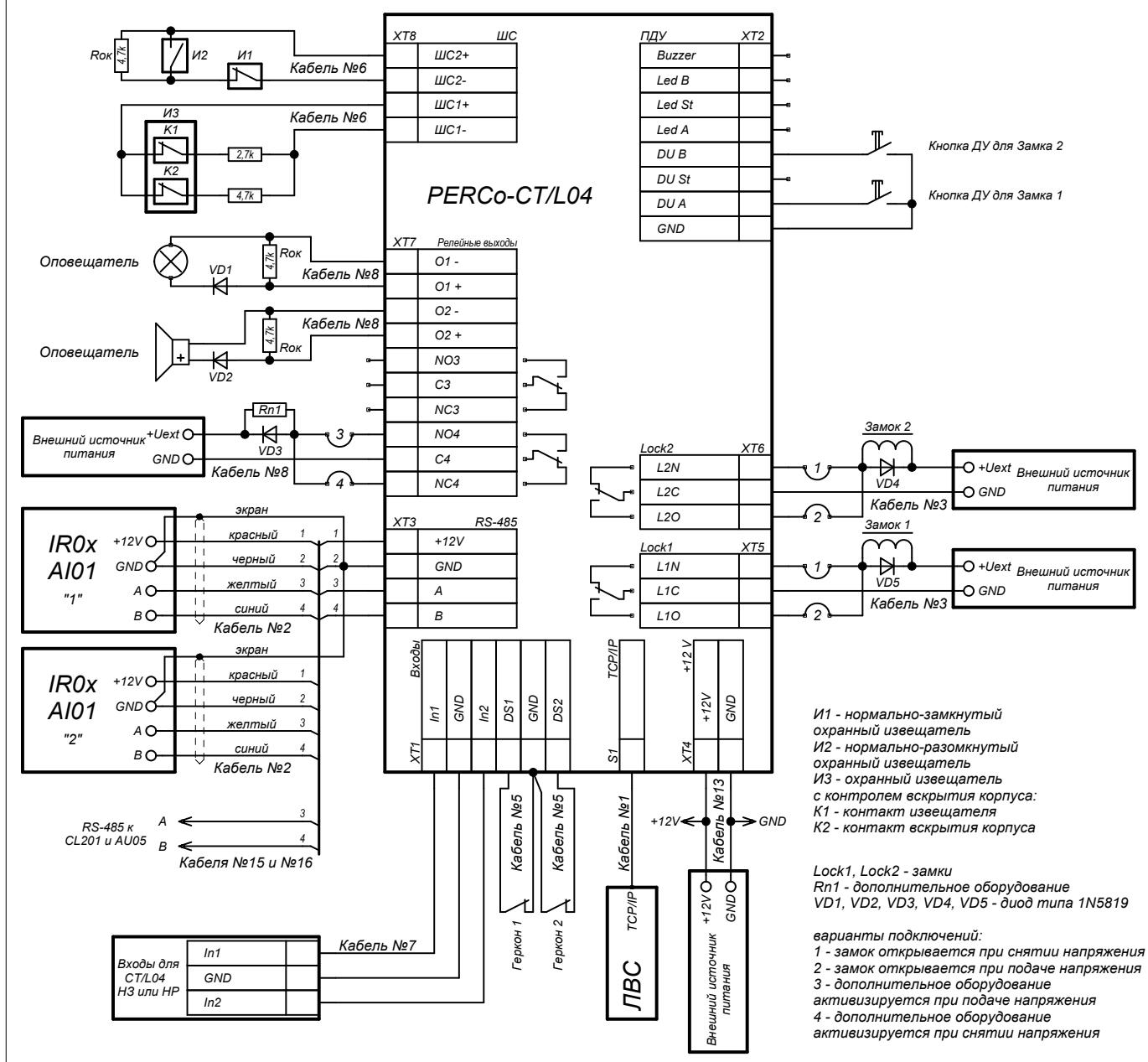
Рисунок 3 – Схема подключений в варианте «управление дверьми»
