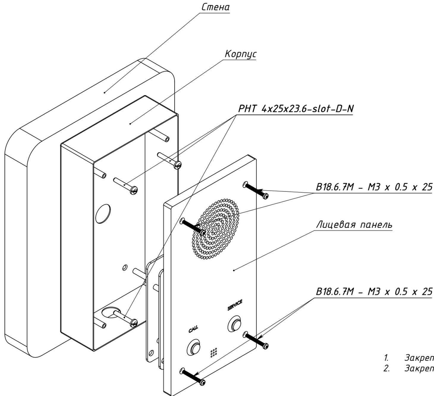
1. Закрепить 4-мя винтами M4x35 Основной корпус к Стене.
