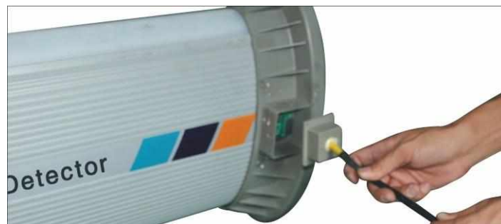
Рисунок 8 – Подключение кабеля электропитания
